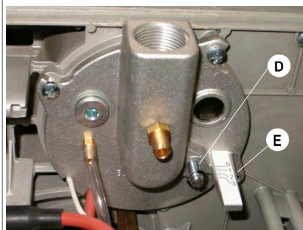
Д ВИНТ РЕГУЛИРОВКИ ДИСКА ПЛАМЕНИ
