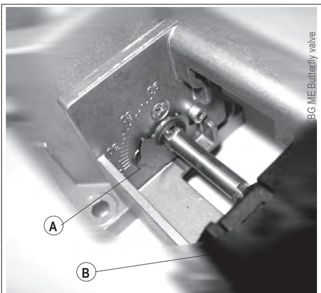
**A** Контрольный показатель положения газового дроссельного клапана.
