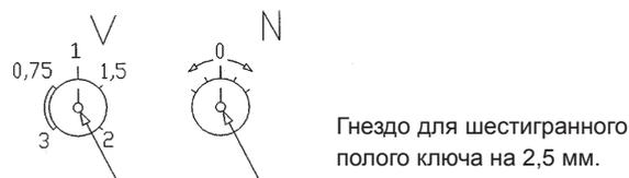
**ВНИМАНИЕ!** Из вышеуказанного очевидно, что изменение давления воздуха горелки посредством устройства регулировки воздуха на головке горения (изменение воздушного зазора) автоматически и неизбежно обуславливает изменение подачи газа.
