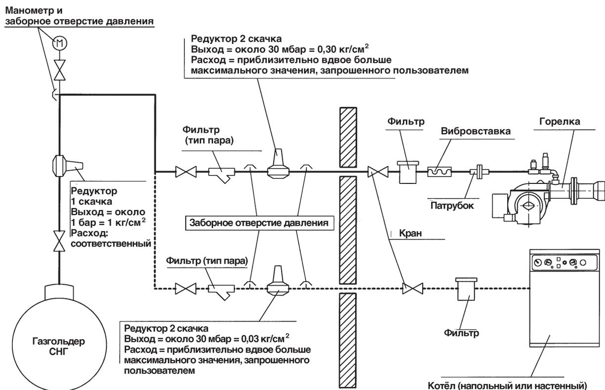
Прим. Не покрывайте изоляционным материалом трубопроводы и редукторы!
