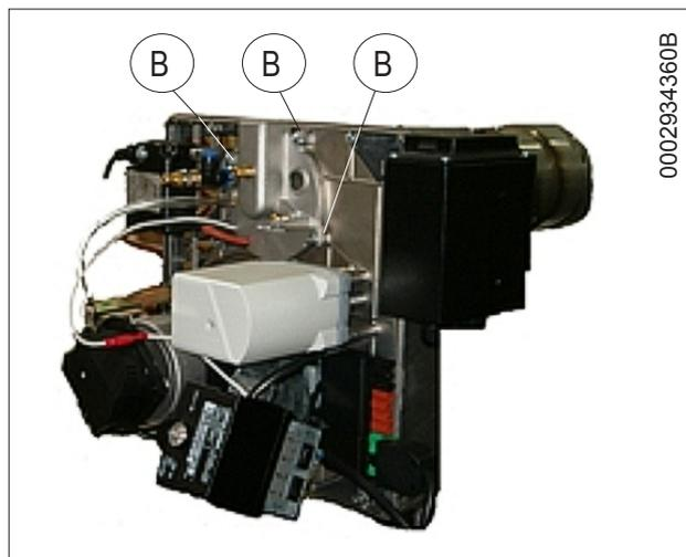
2) После отсоединения газовой рампы открутите 3 винта "В", которые фиксируют к пластине горелки фланец газоподводящего патрубка.
