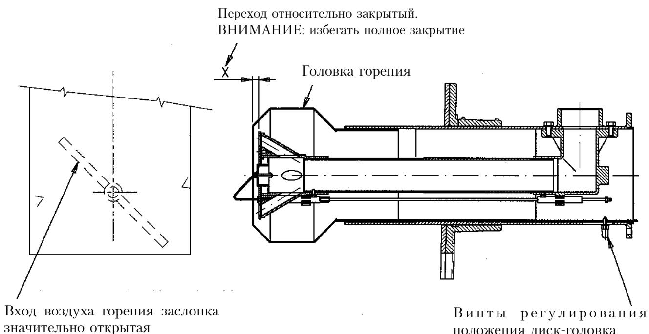
ПРИНЦИПИАЛЬНАЯ СХЕМА РЕГУЛИРОВАНИЯ ВОЗДУХА
