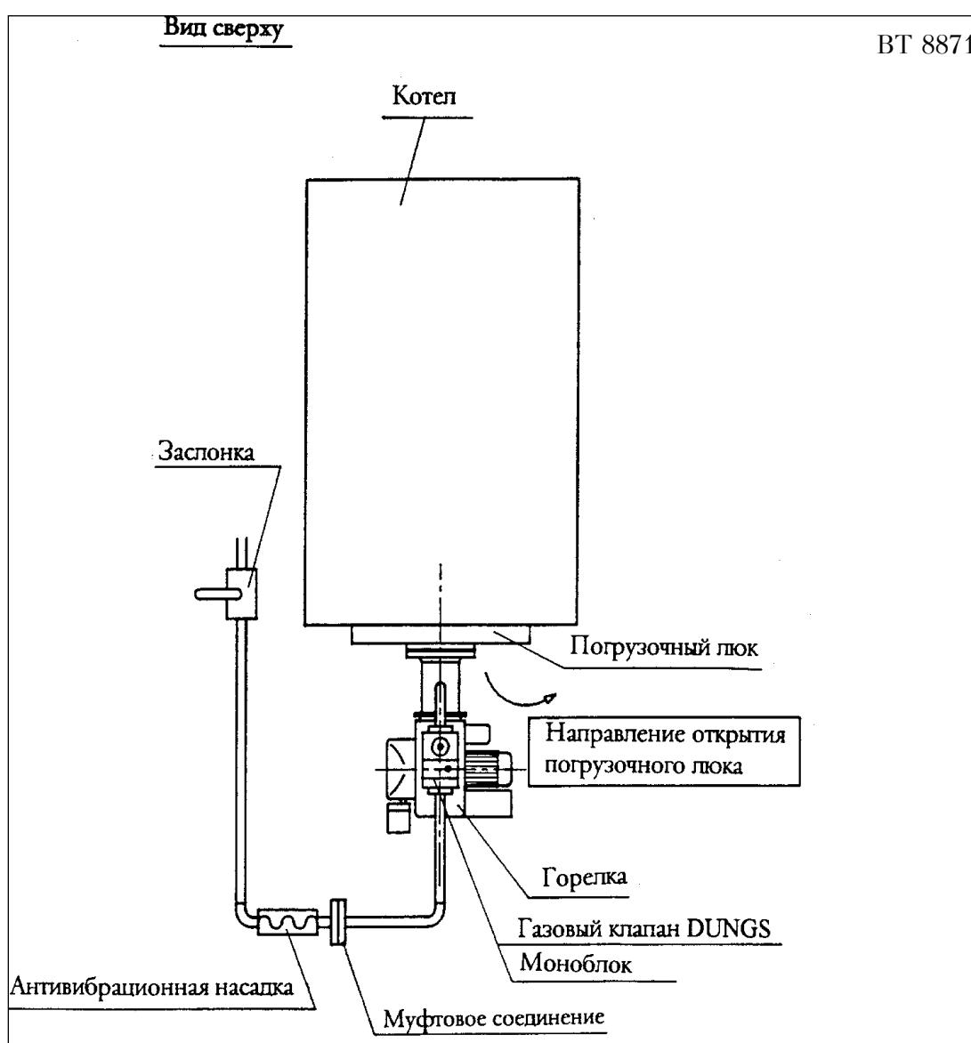
ПРИНЦИПИАЛЬНАЯ СХЕМА РЕГУЛИРОВАНИЕ ВОЗДУХА
