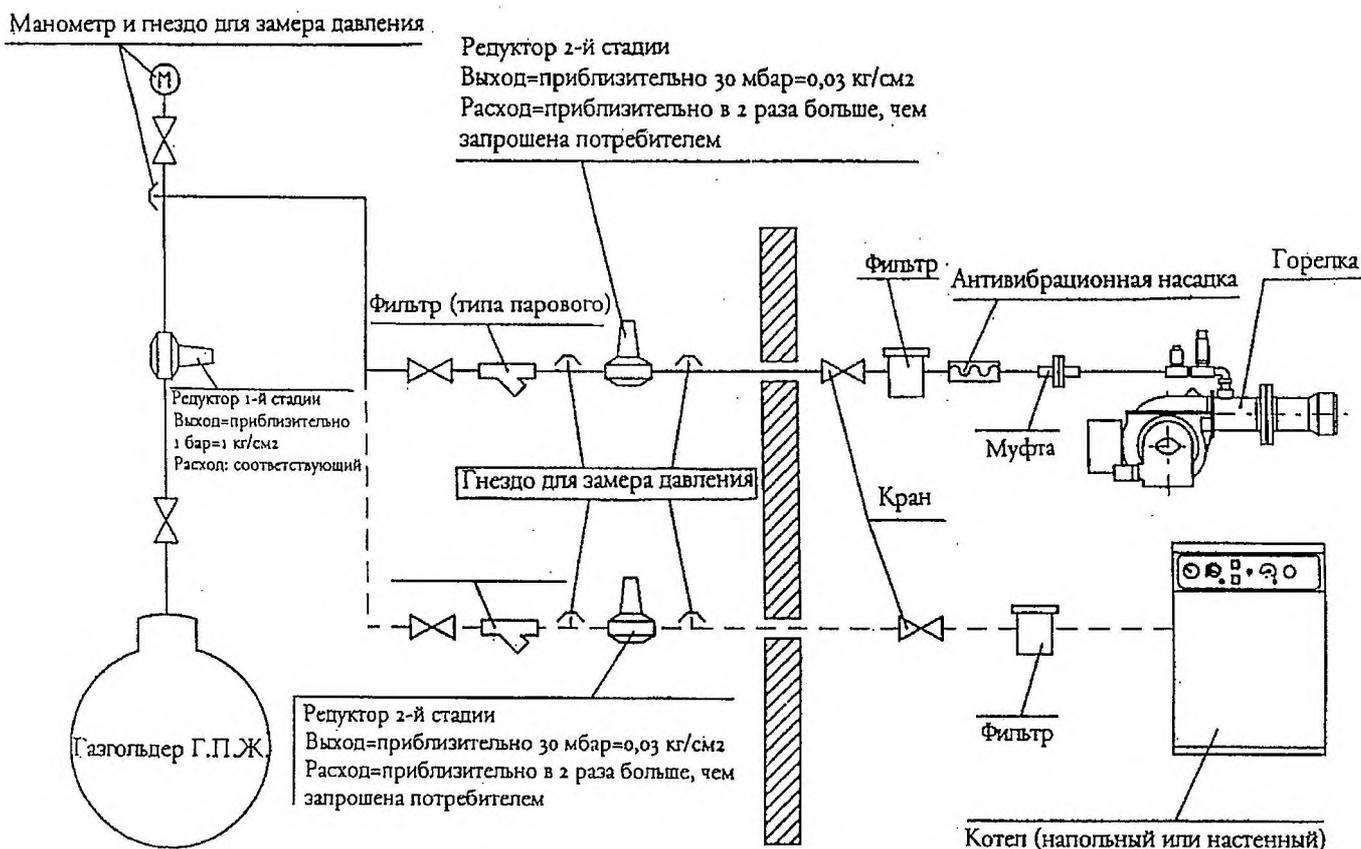
Примечание: Не закрывать трубопроводы и редукторы изолирующим материалом.
