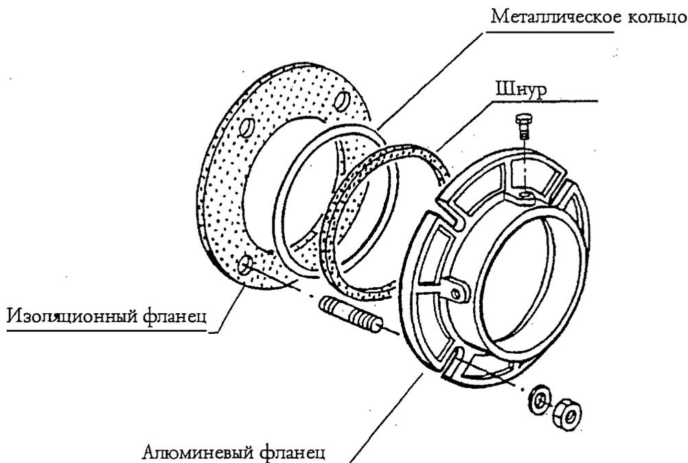
В момент крепления горелки на котел следует правильно установить фланец так, чтобы смесительная головка вошла внутрь топки на величину, указанную изготовителем котла. По окончании правильного крепления горелки на котел, следует позаботиться о его подсоединении к газопроводу.
